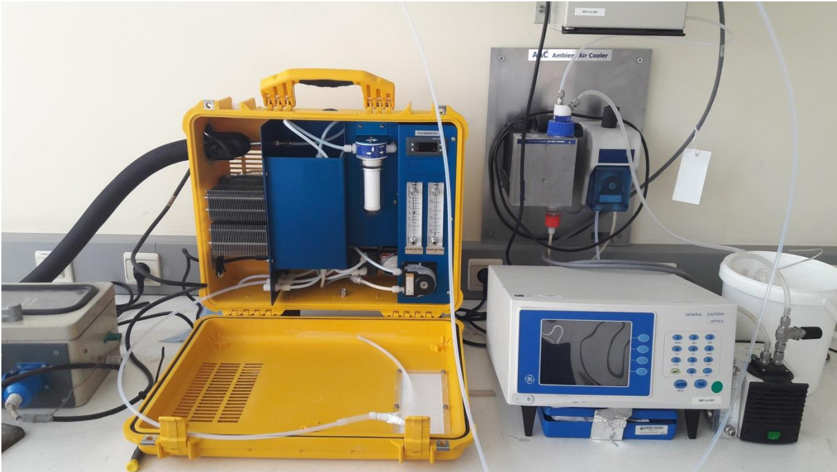
Figuur 2: Peltier koeler 2 (1-kanaals) geïntegreerd in een draagbaar gasconditionerings- en bemonsteringssysteem)
