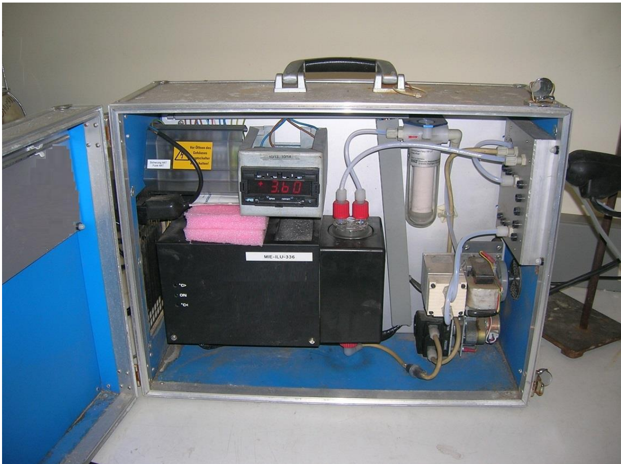
Figuur 1: Peltier koeler 1 geïntegreerd in een draagbaar gasconditionerings- en monsternemingssysteem gebruikt bij de laboratoriumtesten
