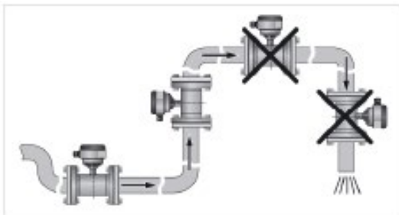
Figuur 8: correcte installatie op laagste punt (links); foutieve installatie op hoogste punt (boven) en voor open uitlaat (rechts)
