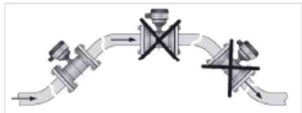
Figuur 7: correcte installatie in gebogen leiding (links); foutieve installatie op hoogste punt (midden) en in gebogen leiding (rechts)
