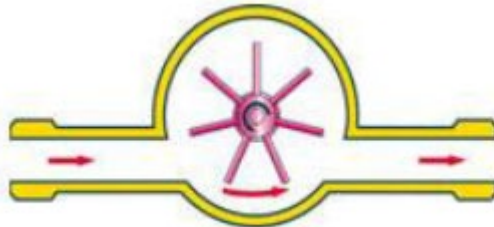
Figuur 17: principe van de enkelstraals vleugelradmeter
