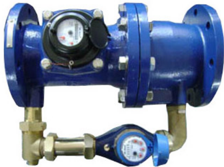
Figuur 11: combinatiemeter met op de hoofdleiding een horizontale Woltmann meter en op de by-pass leiding een meerstraalse turbinemeter en schakelklep
