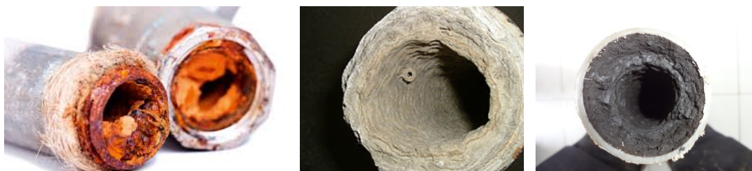
Figuur 4: (links) ijzeroxide-aanslag; (midden) kalkaanslag; (rechts) zwarte mangaanneerslag in leiding
