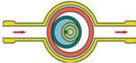
Figuur 21: principe van een volumetrische watermeter
