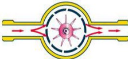
Figuur 18: principe van de meerstraals vleugelradmeter
