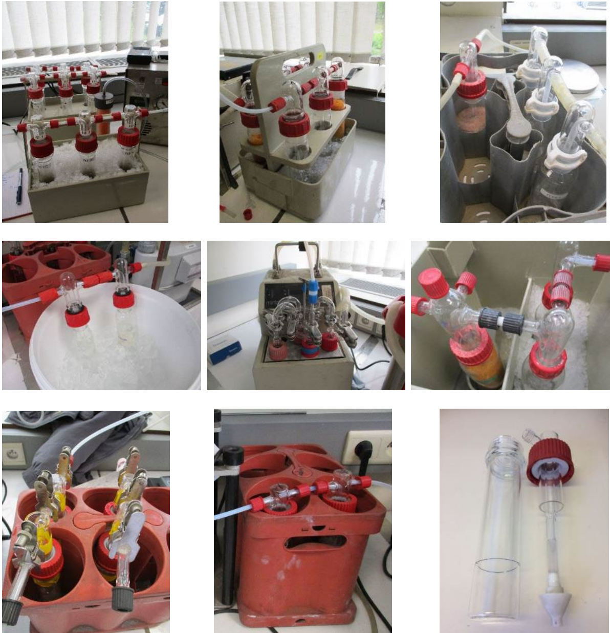
Figuur 5: Voorbeelden van HF-bemonsteringsopstellingen tijdens de LABS 2018-6 ringtest
