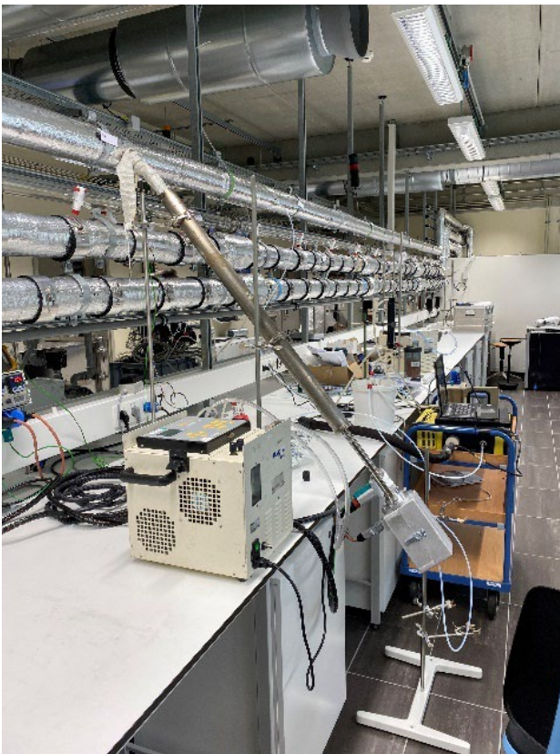
Figuur 35: Metingen met FTIR na een verwarmde sonde om eventuele HF-verliezen in de glazen liner en filterhouder of op de filter te onderzoeken
