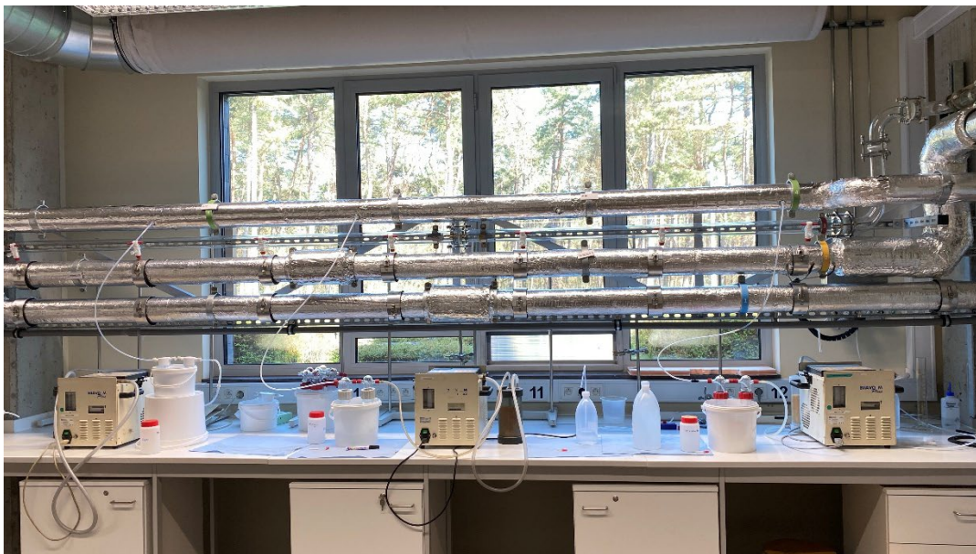
Figuur 29: Natchemische monsternemingen: HF-terugvinding in functie van het materiaal van de wasfles, het waterdampgehalte van de gasstroom en de HF-concentratie
