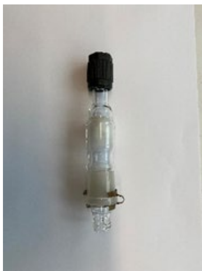
Figuur 36: glazen filterhouder met glaswol propfilter
