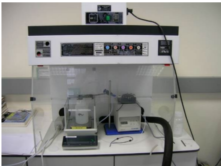
Figuur 13: HF-generatiesysteem vanuit vloeistof
