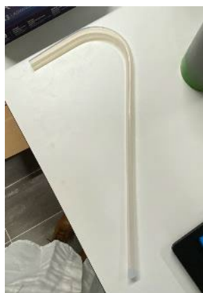
Figuur 24: PTFE insteekstuk met vernauwing voor een wasfles
