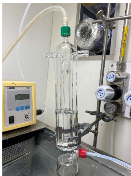
Figuur 25: Speciaal geconstrueerde borosilicaatglazen wasfles om HF-verliezen in het insteekstuk na te gaan
