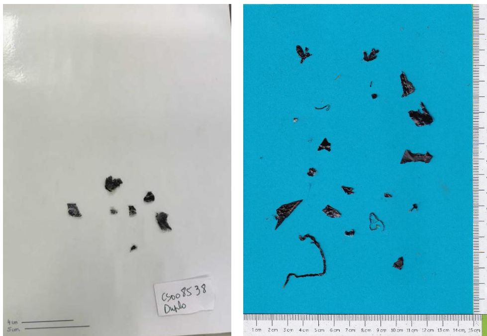
Figuur 18 Voorbeeld zachte plastic fractie > 2 mm in biomix - Lab 1 (links) en Lab 2 (rechts)
