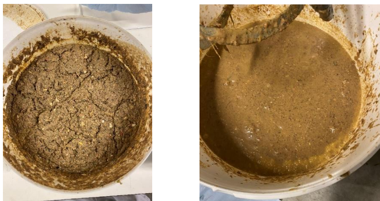
Figuur 3 Biomix vóór (links) en na (rechts) homogeniseren met betonmixer
