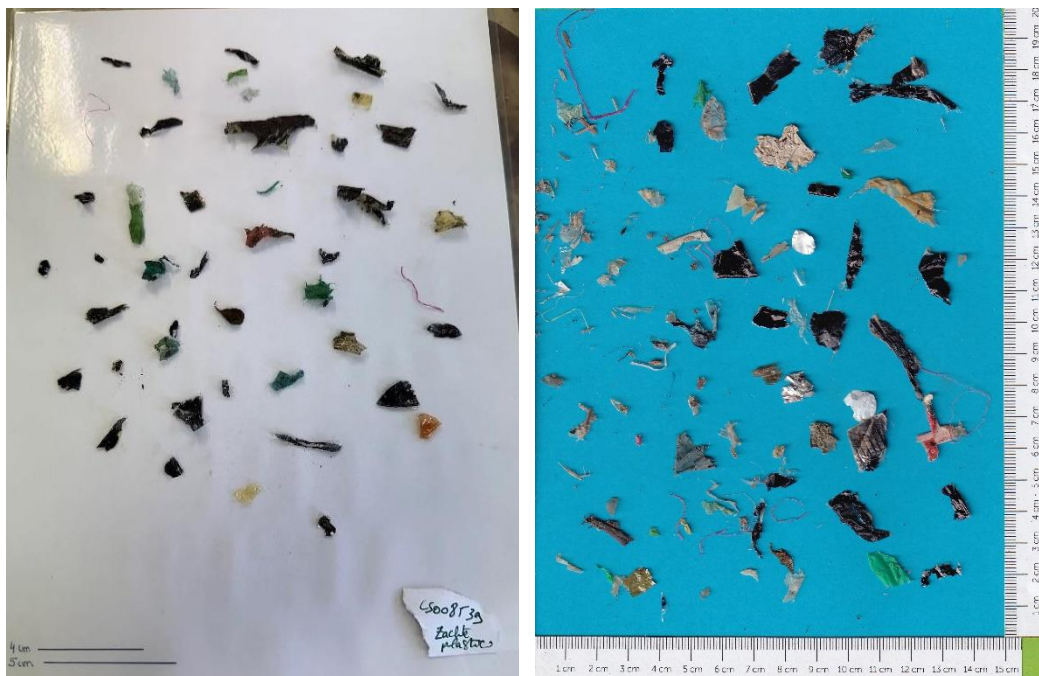
Figuur 12 Voorbeeld zachte plastic fractie > 2 mm in digestaat - Lab 1 (links) en Lab 2 (rechts)
