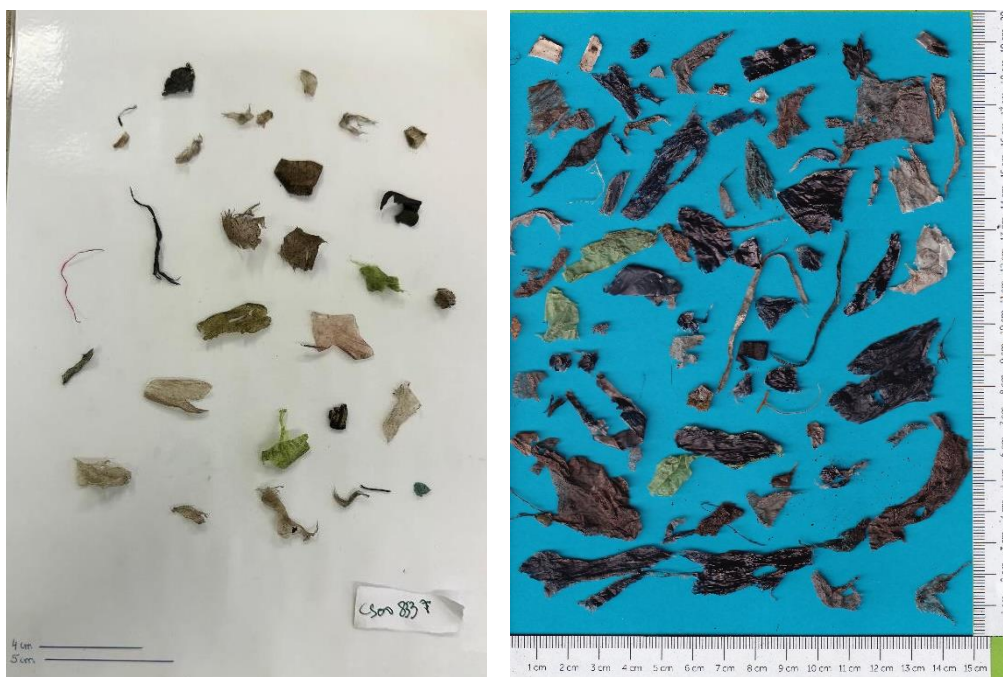
Figuur 7 Zachte plastic fractie > 2 mm in compost - Lab 1 (links) en Lab 2 (rechts)
