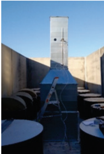
Figuur 2: Opzetstuk voor het uitvoeren van metingen tijdens de validatietesten
