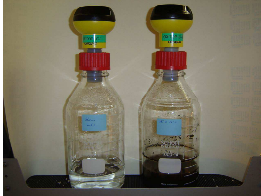
Figuur 1. Foto van de Oxítóp® op het schudtoestel: links blanco, rechts een compoststaal.
