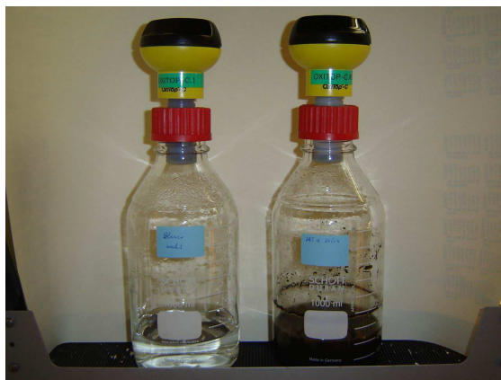
Figuur 1: Foto van een gesloten respirometer met drukmeetekop en adapter
