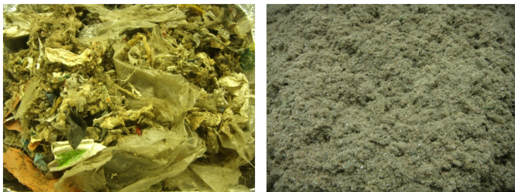
Figuur 9 Monster 7: RDF van restplastic huishoudelijk afval (links:origineel; rechts: < 1 mm)
