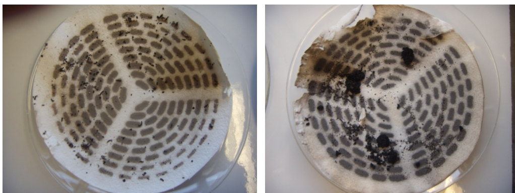
Figuur 17 MDF residu (monster 1, links) en treinbilzen (monster 4, rechts) na selectieve oplosmethode, filtratie en drogen
