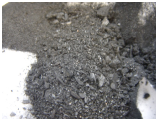
Figuur 20 Torrcoal (monster 8) na selectieve oplosmethode, filtratie en drogen
