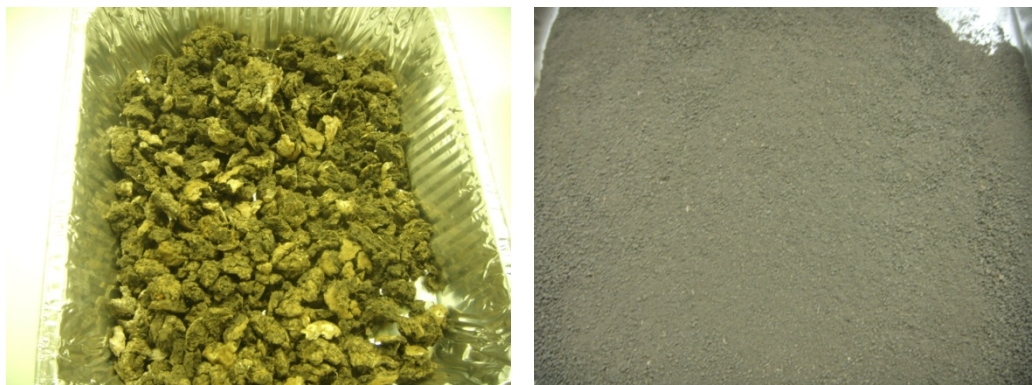
Figuur 7 Monster 5: Filterkoek waterzuiveringsinstallatie (links: origineel; rechts: < 1 mm)
