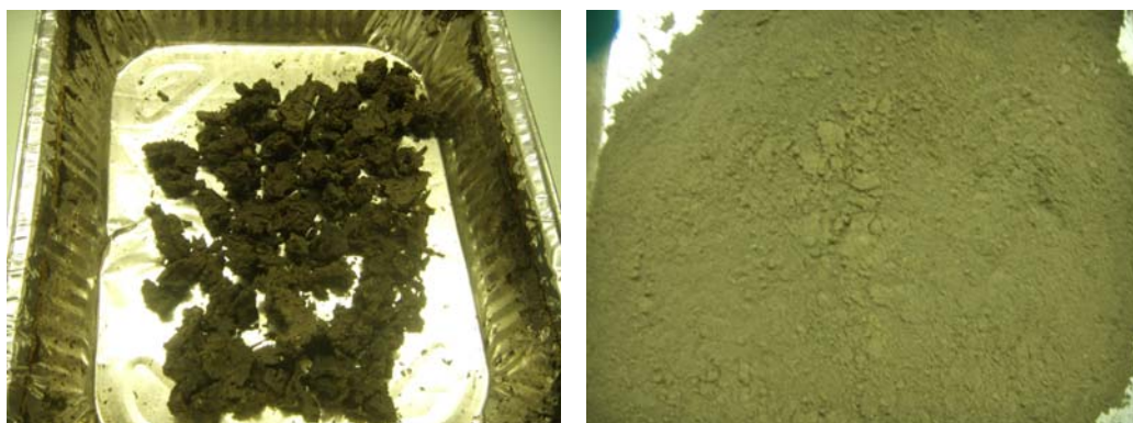
Figuur 8 Monster 6: Nat slib waterzuiveringsinstallatie (links:gedroogd monster; rechts: < 1 mm)
