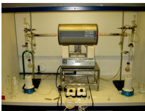
Figuur 4: Hydrolyse opstelling
