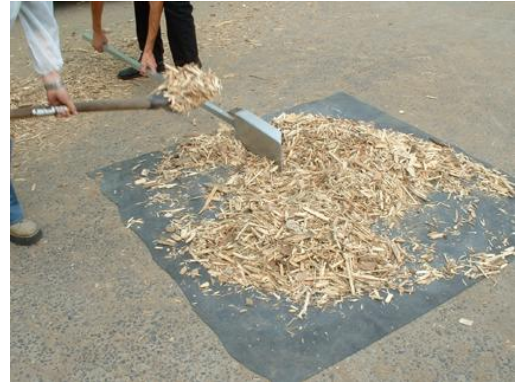
Foto 3a/b: Reduceren van het mengmonster m.b.v. kwarteertechniek
