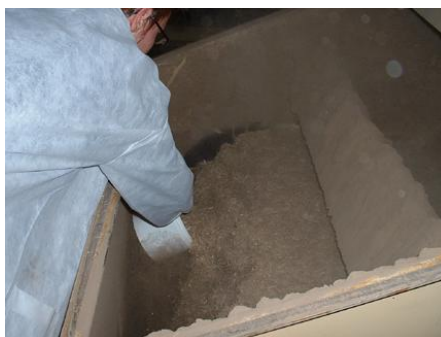
Foto 5: Staalname spaanderplaatproductie na opmenging met zuiver hout
