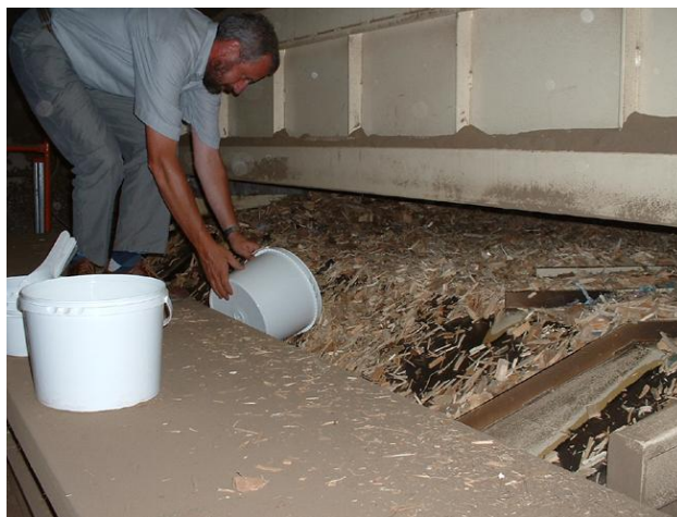
Foto 4: Bemonstering houtspaanders aan het eindpunt van het opschoningsproces
