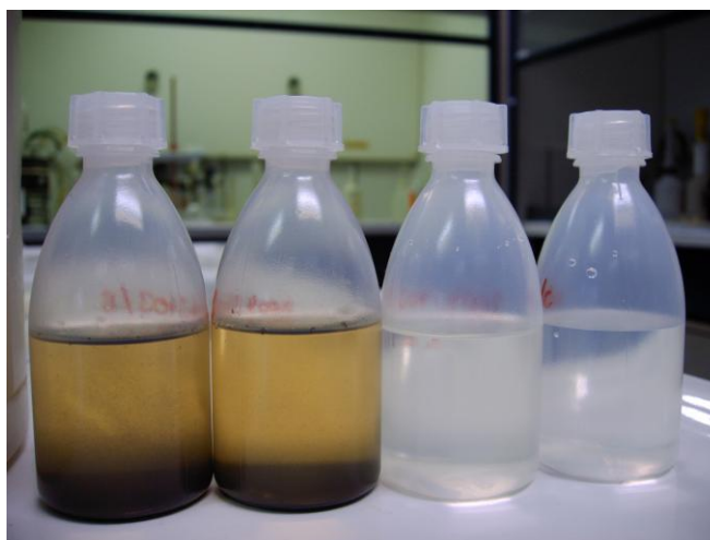
Foto 6: Destructieoplossingen zonder (links) en na voorafgaandelijke verassing (rechts)
