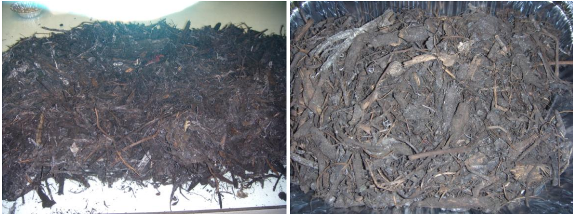
Foto 2: Zeefoverloop: origineel monster (links) en na drogen 105°C (rechts)
