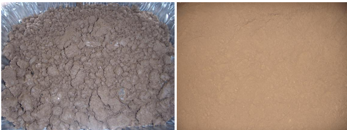
Foto 10: Zuiveringsslib: origineel monster (links) en verfijnd monster (rechts)
