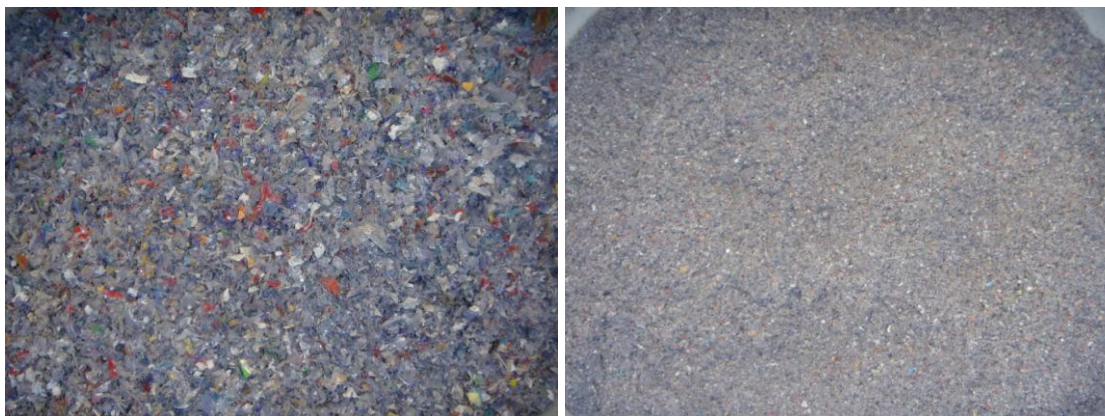
Foto 8: RDF fractie < 4 mm (links) en < 0.5 mm (rechts)
