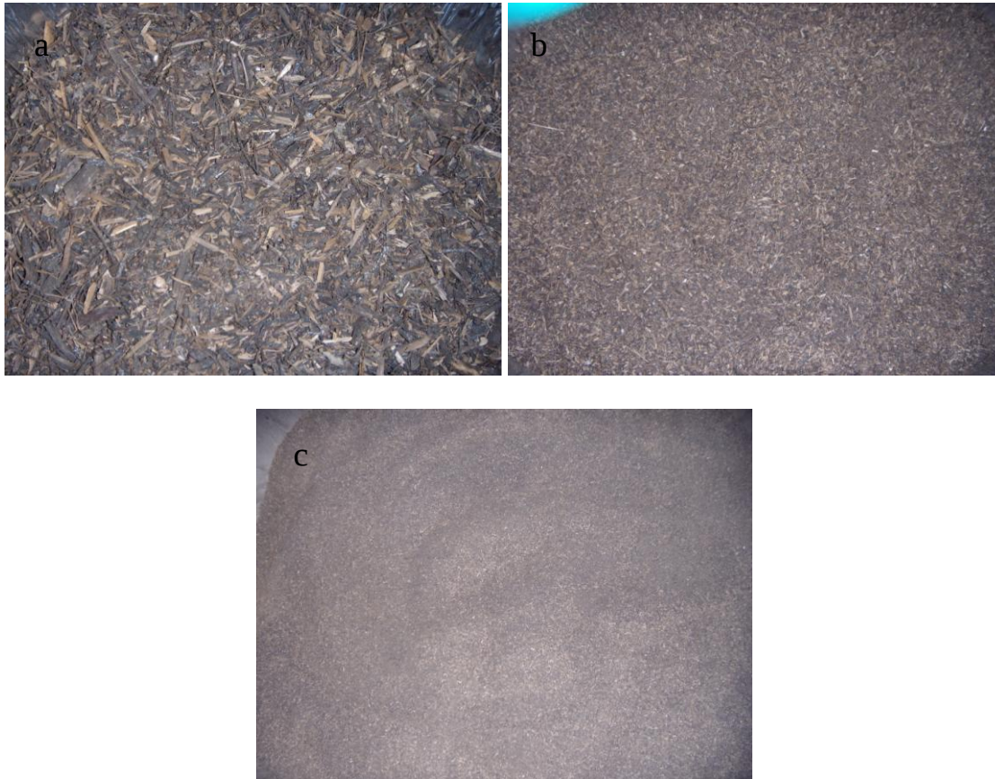
Foto 5: Zeefoverloop fractie < 2 cm (a), < 2 mm (b) en < 0.5 mm (c)
