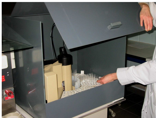
Figuur 8: Voorbeeld afscherming cyanide carousel
